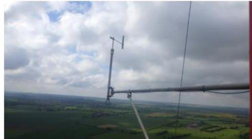
L'appareil de gauche est l'anémomètre placé tout en haut du mât, il est composé de coupelles qui tournent autour d'un axe en fonction de la force du vent, la fréquence de rotation est transformée en une vitesse de vent en m/s.
